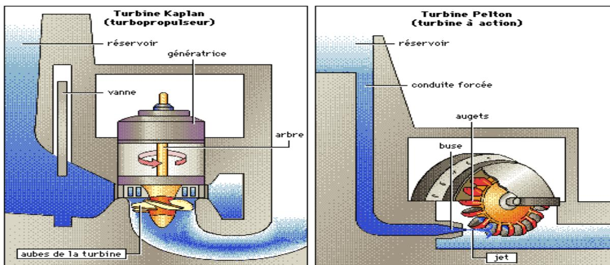
Graphe présentant le type de turbine utilisé en fonction des caractéristiques du barrage :
