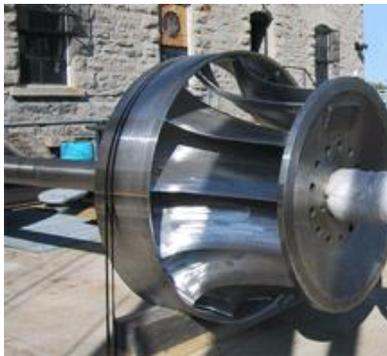
Utilisées par un fort rendement dans des chutes de 40 à 300 m. possédant des immenses réservoirs d'eau elles arrivent à développer une puissance régulière et forte qui couvre généralement les demandes d'électricité. Sa composition est une conduite en colimaçon ou bêche en spirale qui met l'eau sous pression dans les directrices (aubage) qui mettent en mouvement perpétuel la roue et l'arbre de la turbine. L'eau s'échappe ensuite au-dessous de la turbine.
